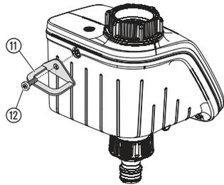
Um den Water Control gegen Diebstahl zu sichern, kann die GARDENA Diebstahlsicherung Art.-Nr. 1815-00.791.00 über den GARDENA Service bezogen werden.
