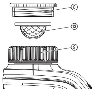
Das Schmutzsieb ⑬ sollte regelmäßig kontrolliert werden und bei Bedarf gereinigt werden.
