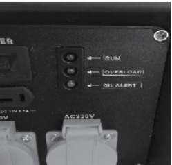
LED-Anzeige für niedrigen Ölstand
