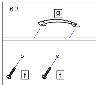
Bei Hochglanz-Fronten bitte erst die Schutzfolie entfernen und dann den Griff montieren!
