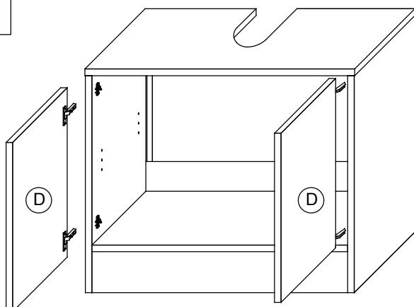
Bei Türmontage das Scharnier einhängen, bis Anschlag öffnen und anschließend festschrauben.
