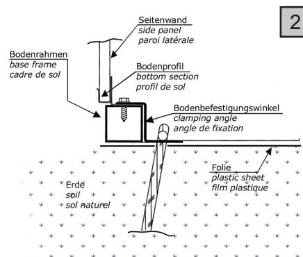
Die **sturmsichere Verankerung** des Gerätehauses machen Sie mittels der Bodenbefestigungswinkel wie folgt:
