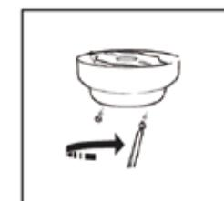
6. Montieren Sie die Flügel mit Schrauben, Unterlegscheiben, Papierunterlegscheiben und Endscheiben aus Papier an den Flügelhalterungen. Befestigen Sie die montierten Flügel mit Schrauben und Sicherungsscheiben am Motor.
