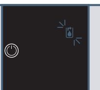
System wird entleert, Gerät schaltet nach Entleerung automatisch ab
