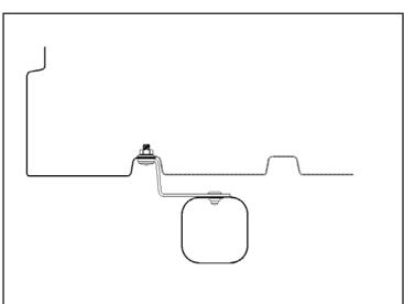
**4. Schieben Sie das Regenfallrohr über den Anschlusspfropfen und befestigen Sie es mit den beiden Schrauben.**
